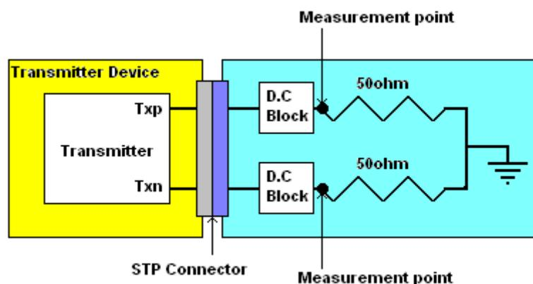
Figure 3 : STP Test Load
