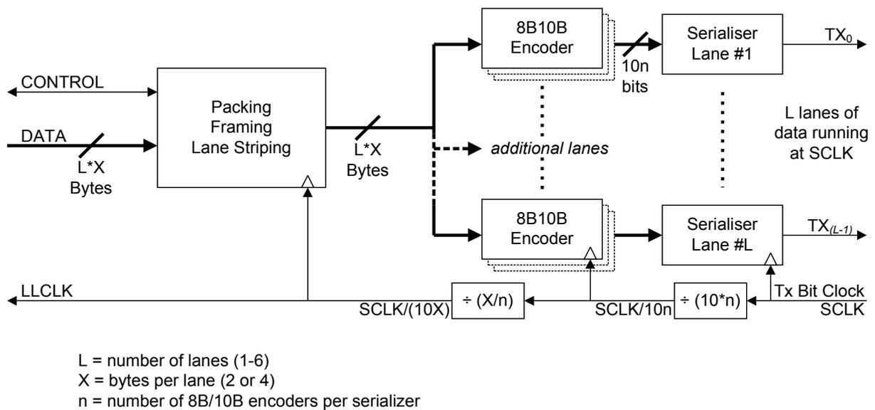
**Figure 6 : Link layer Tx block diagram**
